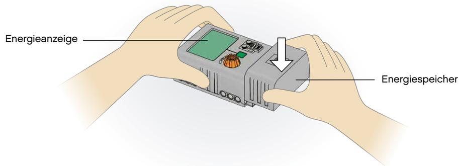
Um den Energiespeicher abzunehmen, muss an der Hinterseite eine Kunststoffflasche gedrückt...
