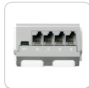
Conexión de motores
